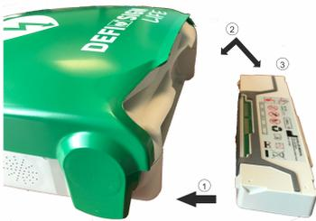
1. Inserire i due blocchi d'arresto situati sotto la batteria nelle aperture del dispositivo.
